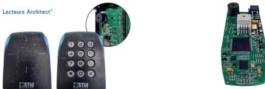
**Aucun dépôt ni oxydation** n'est présent sur les nappes de l'antenne et du clavier.
