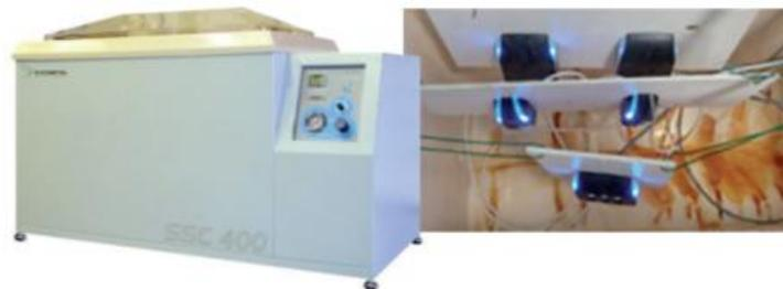
**Résultats** : à la fin du test, **les lecteurs sont toujours fonctionnels** (LEDs en mode Rainbow, lecture et remontée du badge, commandes externes, puce UHF...) Un **léger dépôt de sel** a été observé, **non perturbant pour le bon fonctionnement**.
