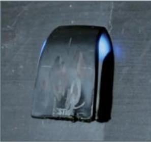
**Description** : test visant à évaluer la résistance du lecteur au feu et sa capacité à rester fonctionnel après une exposition directe aux flammes.
