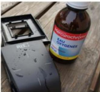
**Descripción:** evaluación de la resistencia química al sumergir carcasas de lectores en amoníaco y peróxido de hidrógeno (H<sub>2</sub>O<sub>2</sub>).
