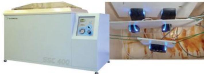
**Resultados:** al finalizar la prueba, **los lectores permanecieron completamente funcionales**. Los LEDs operaban en modo arcoíris, los datos de la tarjeta se leían y transmitían correctamente, el dispositivo respondía a comandos externos y el chip UHF funcionaba normalmente. Se observó **un leve depósito salino** en la superficie del lector, **sin ningún impacto sobre su funcionamiento**.
